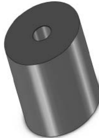
Figura 4– Matriz padrão para corpos de prova 70Cu-30Ni
