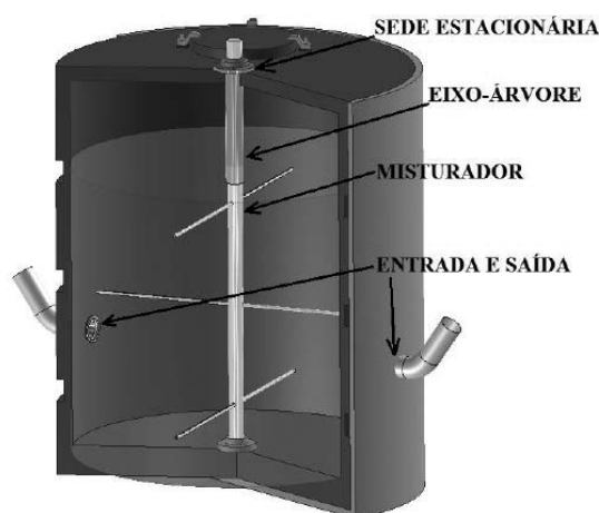
Figura 1 – Aplicação de face estacionária em biorreator contínuo com misturador
